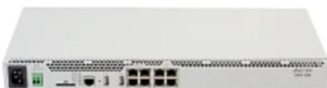
**IP ATC SMG-500: 250 SIP абонентов с опциональным расширением до 500, 4 порта 10/100/1000Base-T (RJ-45), 2 порта USB 2.0, до 4 портов E1**
