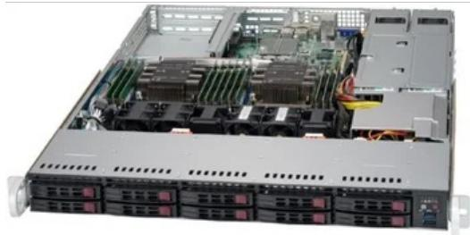
Платформа Supermicro 1U SYS-1029P-WTRT, Два процессора Intel Xeon Scalable, DDR4, 10x2,5" HDD SATA, 2x10GBase-T
