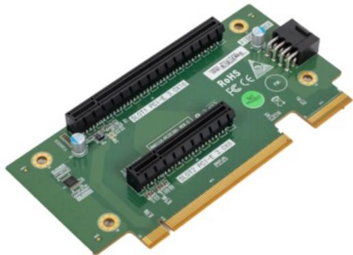
Адаптер 1x PCI-Ex16 / 1x PCI-Ex8 для серверов SNR 2U серии RS/RE RM2112-PCIEIB1 PCBA VER.B
