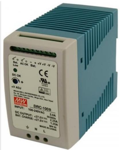
**DRC-100B Блок питания с функцией ИБП на DIN-рейку, выход: 27.6В/0...3.5 (2.25 ном.) А, выход зарядного устройства: 27.6В/1.25А, изоляция 3000В AC**
