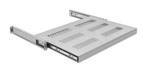
Полка выдвижная для шкафов глубиной от 800 до 1000мм (глубина полки 550мм), распределенная нагрузка 20кг, цвет-серый
