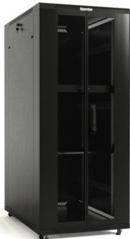
**Шкаф напольный 19-дюймовый, 42U, 2055x800x1000 мм (ВхШхГ), передняя и задняя распашные перфорированные двери, 2 вертикальных кабельных организатора**
