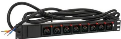
**Блок розеток серии SNR-PDU с локальным измерением на 8xC13/C19 с фиксаторами, шнур питания 3м 3x2.5мм<sup>2</sup> без вилки, 230В, 16А**
