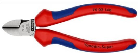
Бокорезы, рез: провол. мягк. d 4 мм, средн. d 2.5 мм, твёрд. d 1.8 мм, L-140 мм, 62 HRC, чёрн., 2-к ручки KN-7002140
