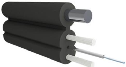
**Кабель оптический B-OptiX, с дополнительным несущим элементом (2\*0,5 FRP + проволока 1.0 мм), 1 волокно
