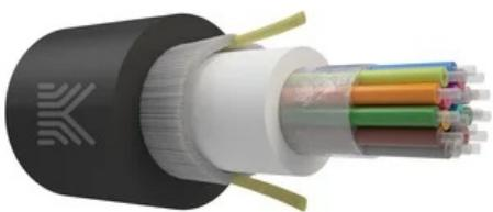
Дроп-кабель круглый, с центральной трубкой, усилен стеклонитями, 16 волокон, SM 9/125, G.657.A1, полиэтилен, 1 кН
