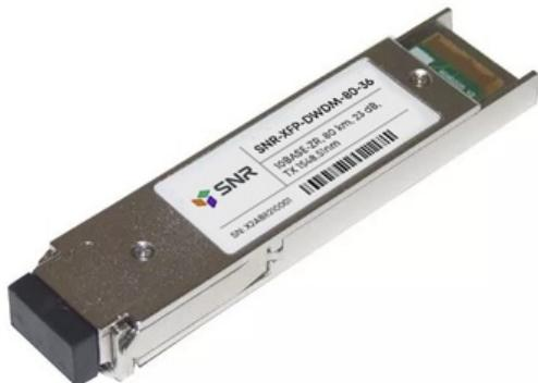
Модуль XFP DWDM оптический,
