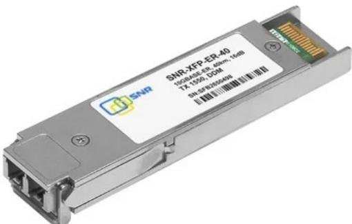
**Модуль XFP оптический,
